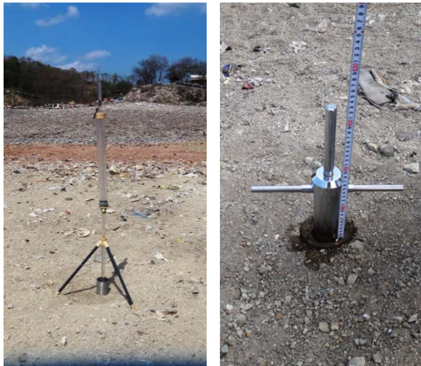
写真-8 透水試験（左）及びサンプリング状況（右）
