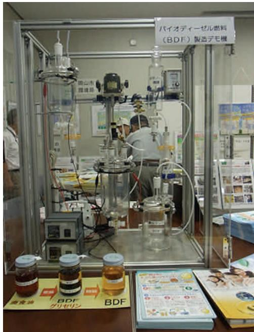
展示の目玉は、バイオディーゼル製造のデモ装置。廃食用油が、実験装置内でバイオディーゼルに代わってゆく様子がデモされた（左写真）。岡山市では実際に食用油が集められて、バイオディーゼルの製造に使われている。展示では、反応の過程がわかりやすく示され、理解が深まった。
