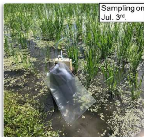
図. 2 チャンバーの模式図およびガスサンプリングの様子
