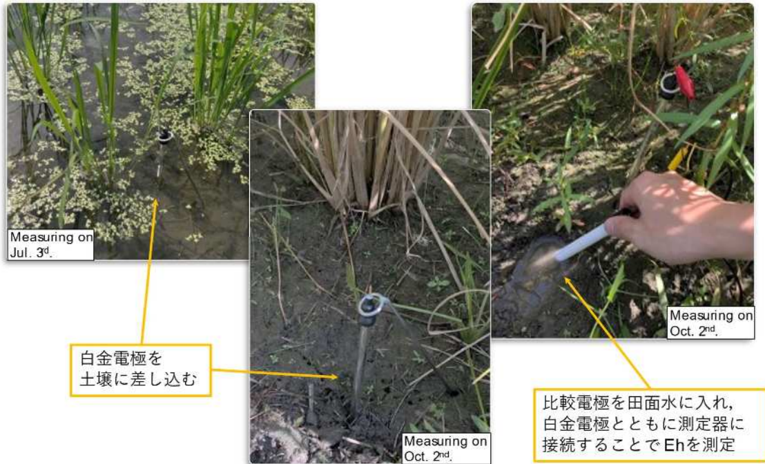
図.4 酸化還元電位 Eh の測定の様子
