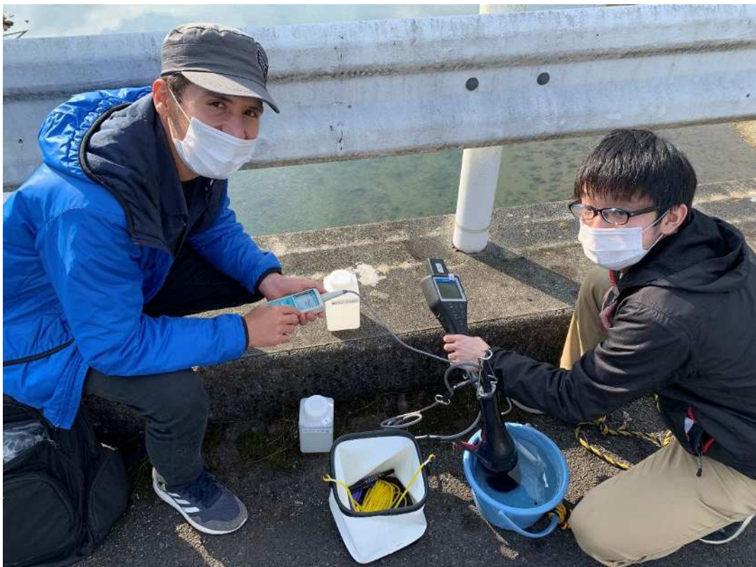
写真2：多項目水質計を用いた現地での水質計測
