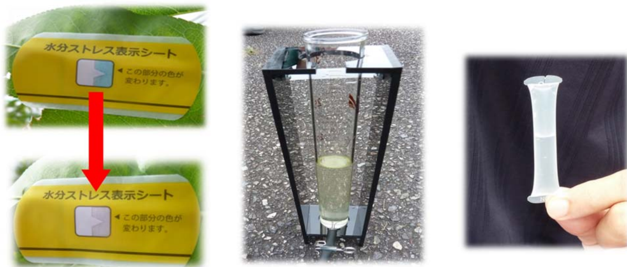
第1図. 調査器具：水分ストレス表示シート(左)、透視度計(中央)、簡易キット(右)
