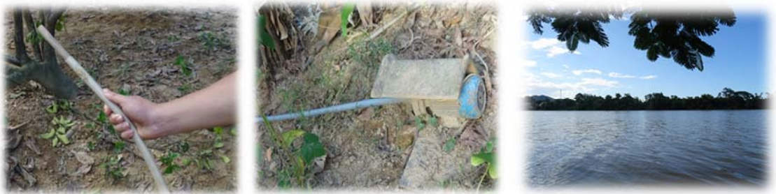
第 8 図 園地②でのかん水システム 河川(右)、ポンプ(中央)、ホース(左)
